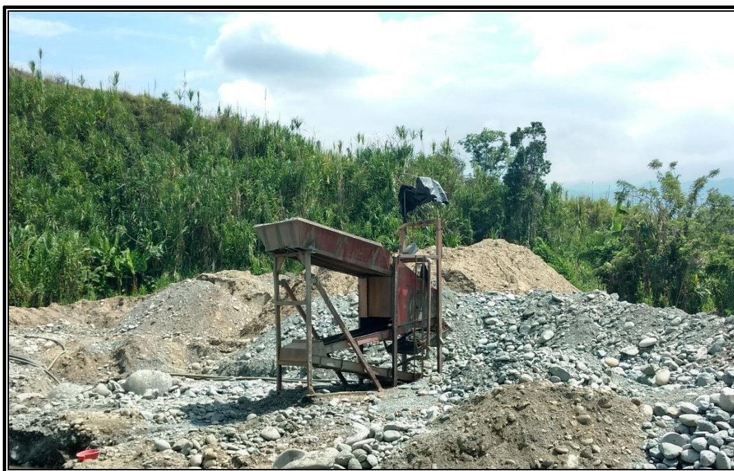
Foto 80 - Classificadora de ouro na beira do rio Palo. Píllamo/Colômbia
