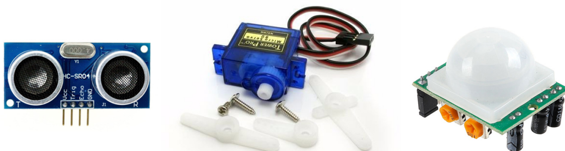
Imagem 42 – Esquerda: Sensor Ultrassônico HC-SR04. Centro: Servomotor 9g Sg90 Tower Pro. Direita: Sensor de presença PIR.
