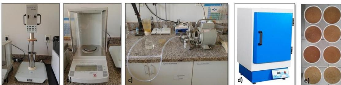
**Figura 19** - a) Dispersor de amostra; b) Balança de alta precisão; c) Filtro; d) Estufa; e) filtro de acetato de celulose com sedimentos.
