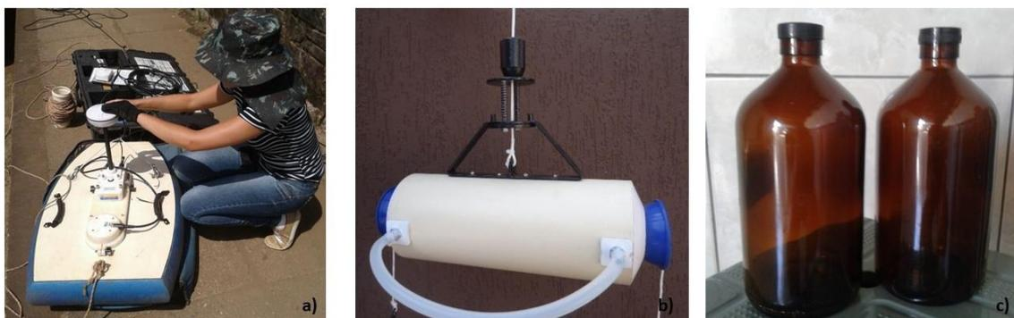
**Figura 18** - a) ADCP; b) Amostrador pontual Garrafa de *Van Dorn*; c) Garrafa de âmbar.
