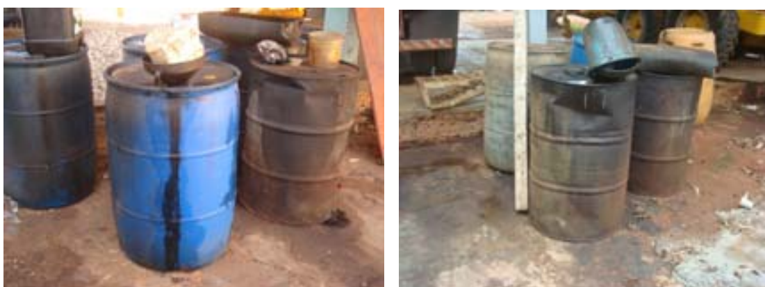
Figura 42 – Armazenagem inadequada de óleo lubrificante usado
