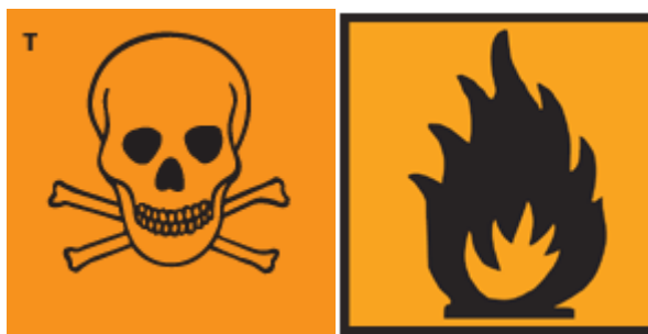
Figura 56 – Símbolos para identificação do local para armazenamento de óleos lubrificantes usados Fonte: GOMES, 2009.
