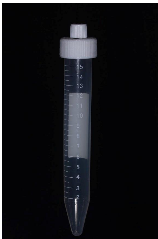
FIGURA 2 -Tubo Falcon de 15 mL acoplado à tampa personalizada produzida em impressora 3 D para processamento de PRP em sistema semifechado.
