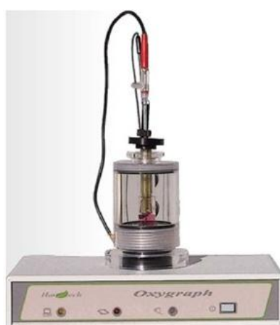
Figura 2.5 - Esquema da célula de eletrodo DW1/AD acoplado com o reator catalítico para oxidação da água.
