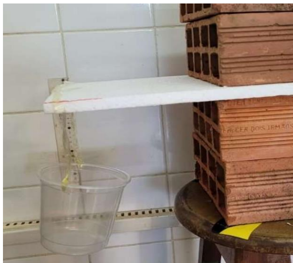
Figura 2.10 – Simulação de uma viga em balanço com carga na extremidade livre (Silva; Vasconcelos, 2023)
