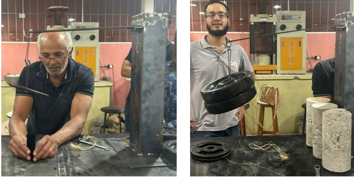
Figura 4.9 – Experimento do Grupo 2: (a) sistema de medição com trena a laser; (b) viga submetida a 20 kg
