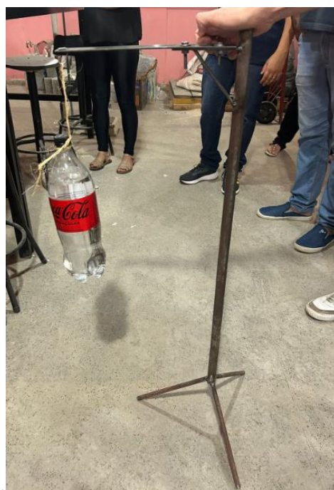
Figura 4.12 – Experimento do Grupo 5: estrutura com cabos simulando o contraventamento
