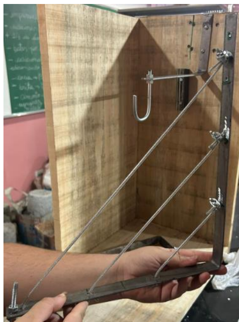
Figura 4.11 – Experimento do Grupo 4: estrutura com cabos simulando o contraventamento
