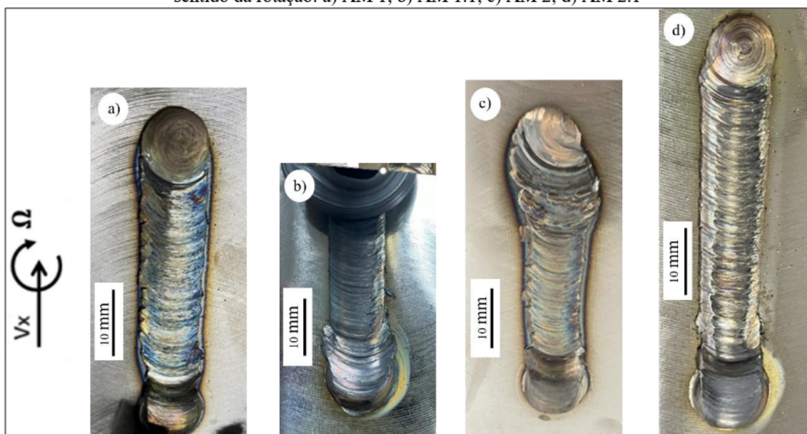
Figura 27 - Vista superior das amostras revestidas com a indicação da direção do avanço horizontal e o sentido da rotação: a) AM 1; b) AM 1.1; c) AM 2; d) AM 2.1
