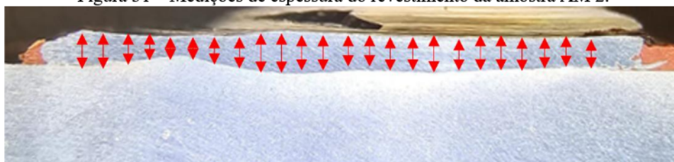
Figura 31 – Medições de espessura do revestimento da amostra AM 2.
