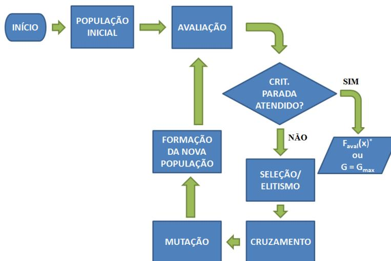
Figura 4.1 - Fluxograma do algoritmo genético básico.
