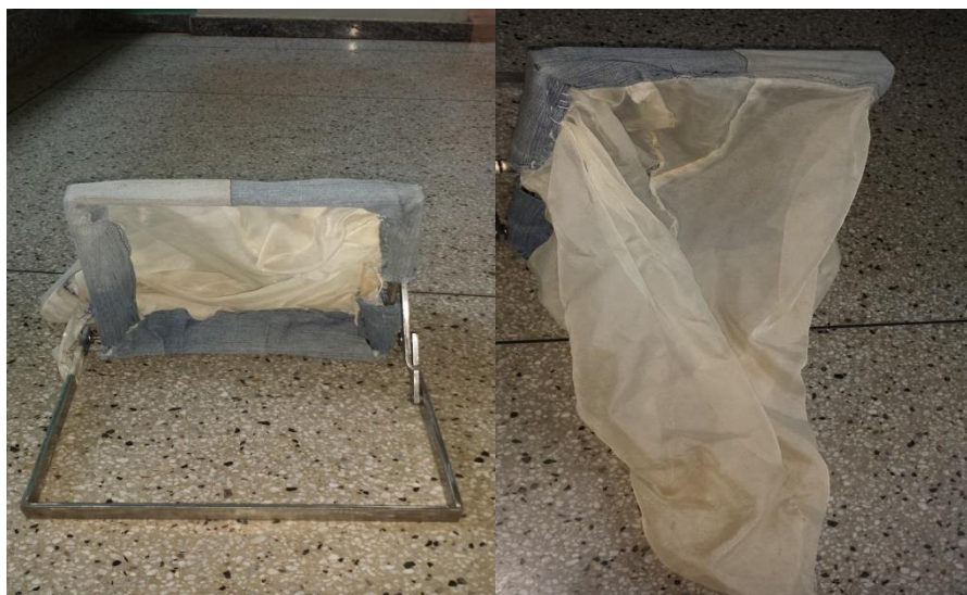
Figura 3: Amostrador do tipo Surber utilizado para coleta de macroinvertebrados aquáticos
