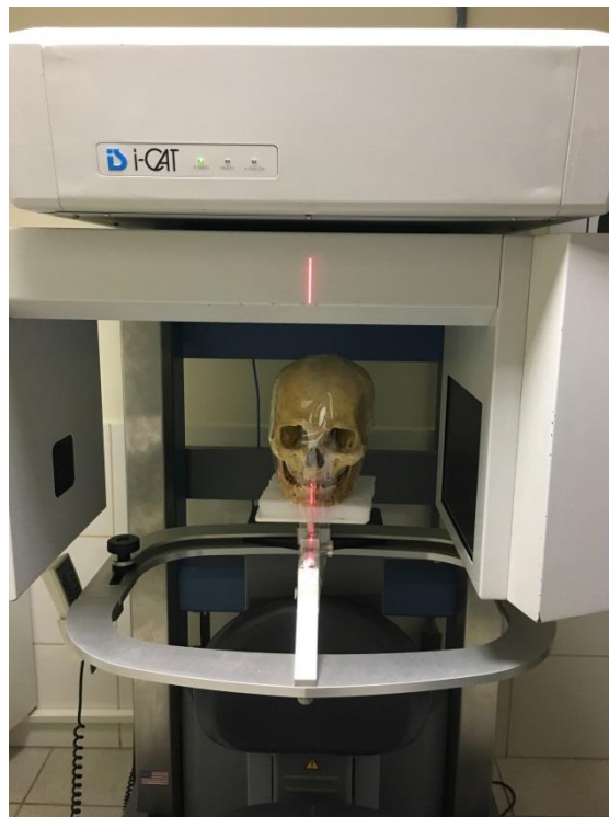
Figura 17. Posicionamento do crânio com os protótipos posicionados no tomógrafo iCAT com o auxílio de uma base confeccionada em isopor.
