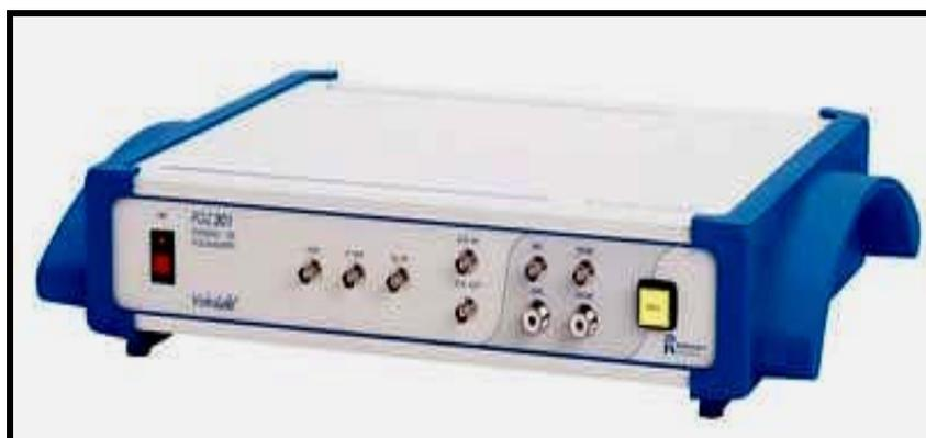
Figura 4.23 – Potenciostato utilizado tipo Voltalab 40 PGZ 301 versão 1.6.
