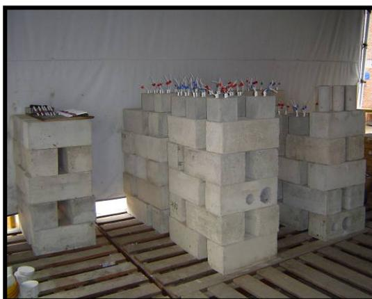
**Figura 4.20 – Corpos-de-prova em local de armazenagem após período de cura úmida.**
