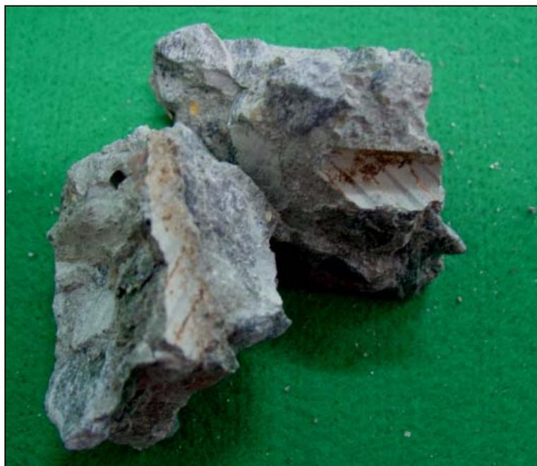
**Figura 5.85 – Concreto R5 próximo à armadura de aço exposta à corrosão por 308 dias.**
