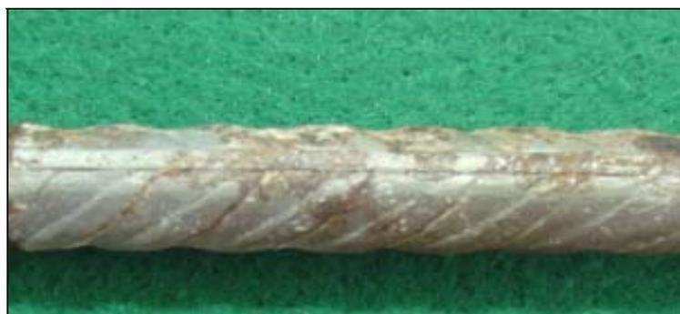
**Figura 5.83** – Aspecto superficial final de uma barra de aço inserida em um concreto de referência e relação  $a/a_g$  0,40, exposta à corrosão por 308 dias de ataque.
