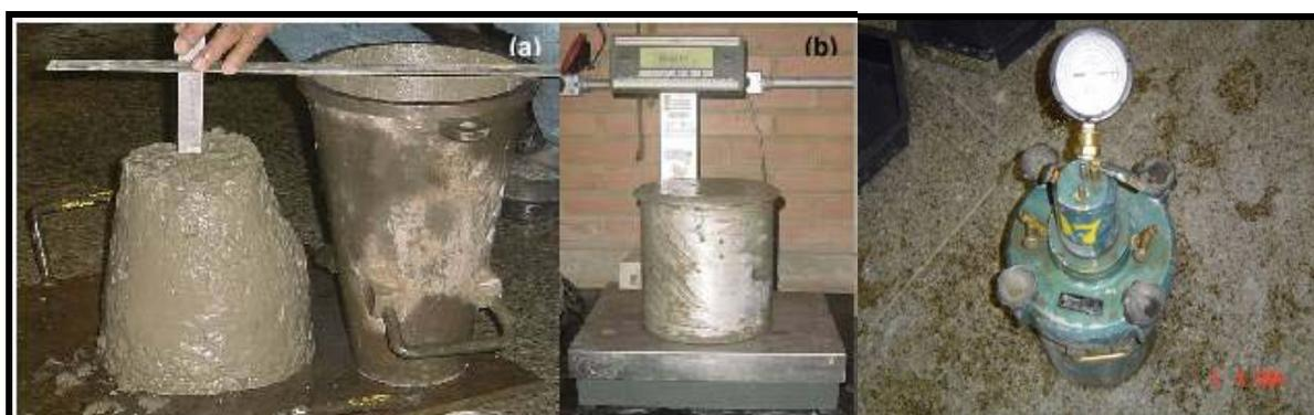
4.6 - Ensaio realizado no concreto fresco: (a) abatimento do tronco de cone, (b) massa específica e (c) teor de ar.
