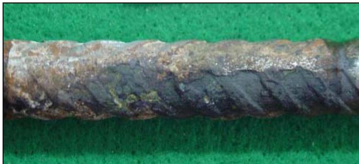
**Figura 5.82** – Aspecto superficial final de uma barra de aço inserida em um concreto de referência e relação  $a/a_g$  0,55, exposta à corrosão por 308 dias de ataque.
