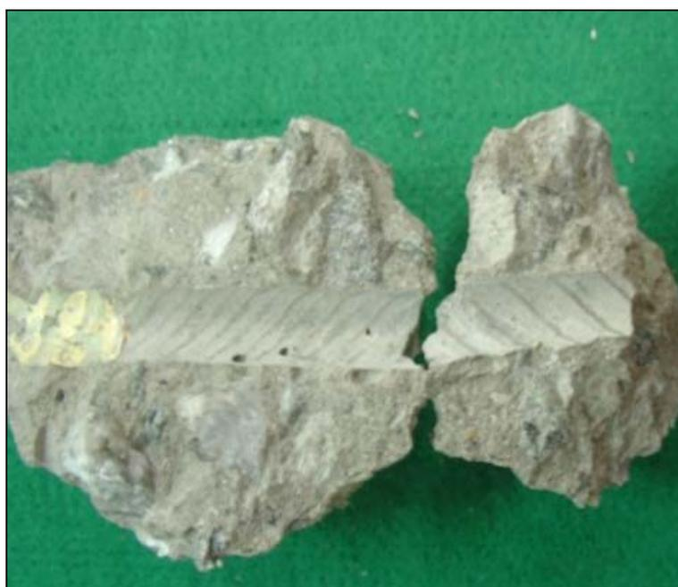
Figura 5.88 – Concreto S5 próximo à armadura de aço exposta à corrosão por 308 dias.
