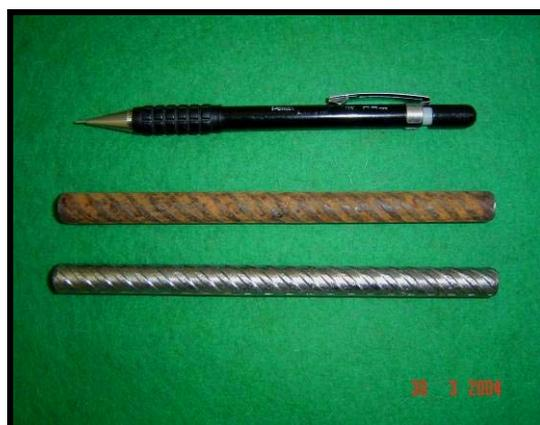
**Figura 4.12 – Barra de aço antes e após a limpeza mecânica com escova de aço, tendo-se óxidos visíveis.**
