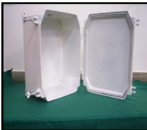
**Figura 4.26 – Gaiola de Faraday utilizada durante as medidas eletroquímicas**
