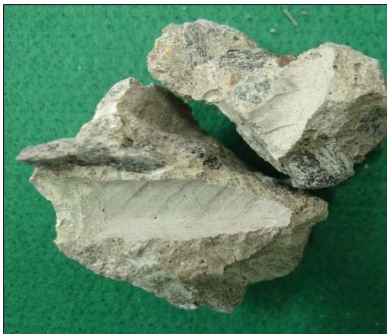
**Figura 5.89 – Concreto M5\_30% próximo à armadura de aço exposta à corrosão por 308 dias.**
