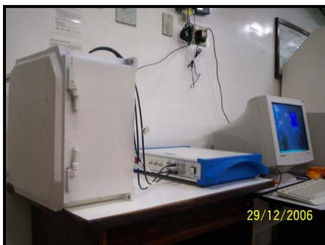
Figura 4.27 – (a) Célula de corrosão ligada ao potenciostato e ao computador.
