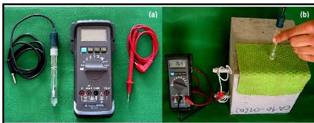
Figura 3.3 - Ensaio de potencial de corrosão: (a) equipamentos utilizados no ensaio e (b) realização do ensaio (FERREIRA, 2003).
