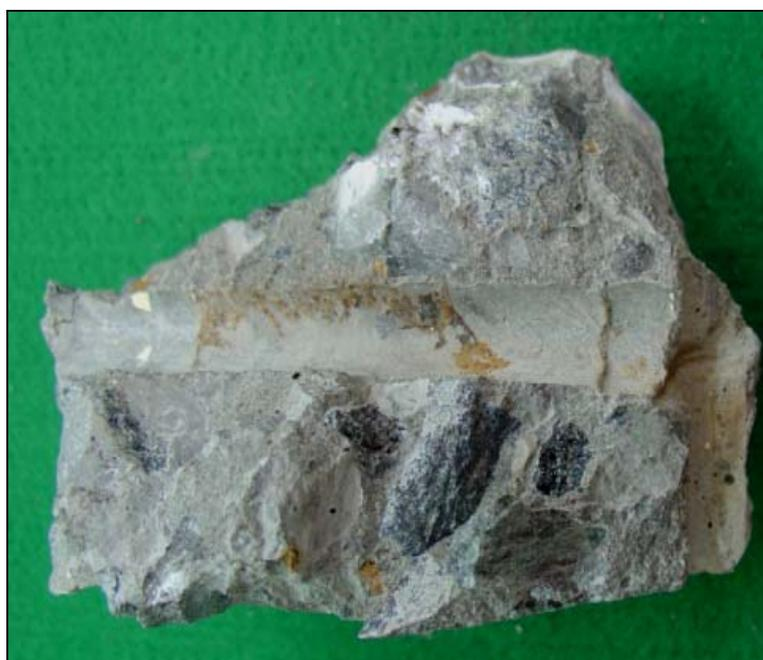
**Figura 5.84 – Concreto R4 próximo à armadura de aço exposta à corrosão por 308 dias.**
