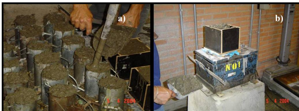
**Figura 4.19 - Colocação do concreto nas fôrmas e adensamento; (a) vibração dos corpos-de-prova cilíndricos com vibrador de imersão e (b) vibração dos corpos-de-prova cúbicos por meio de mesa vibratória.**
