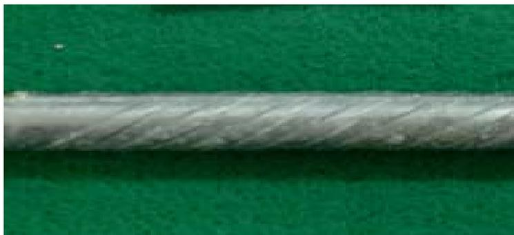
Figura 5.86 – Aspecto superficial final de uma barra de aço inserida no concreto S5 exposto à corrosão por 308 dias de ataque.
