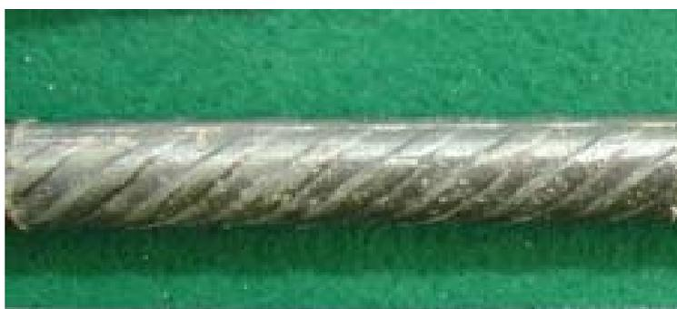
Figura 5.87 – Aspecto superficial final de uma barra de aço inserida no concreto M5\_30% exposto à corrosão por 308 dias de ataque.
