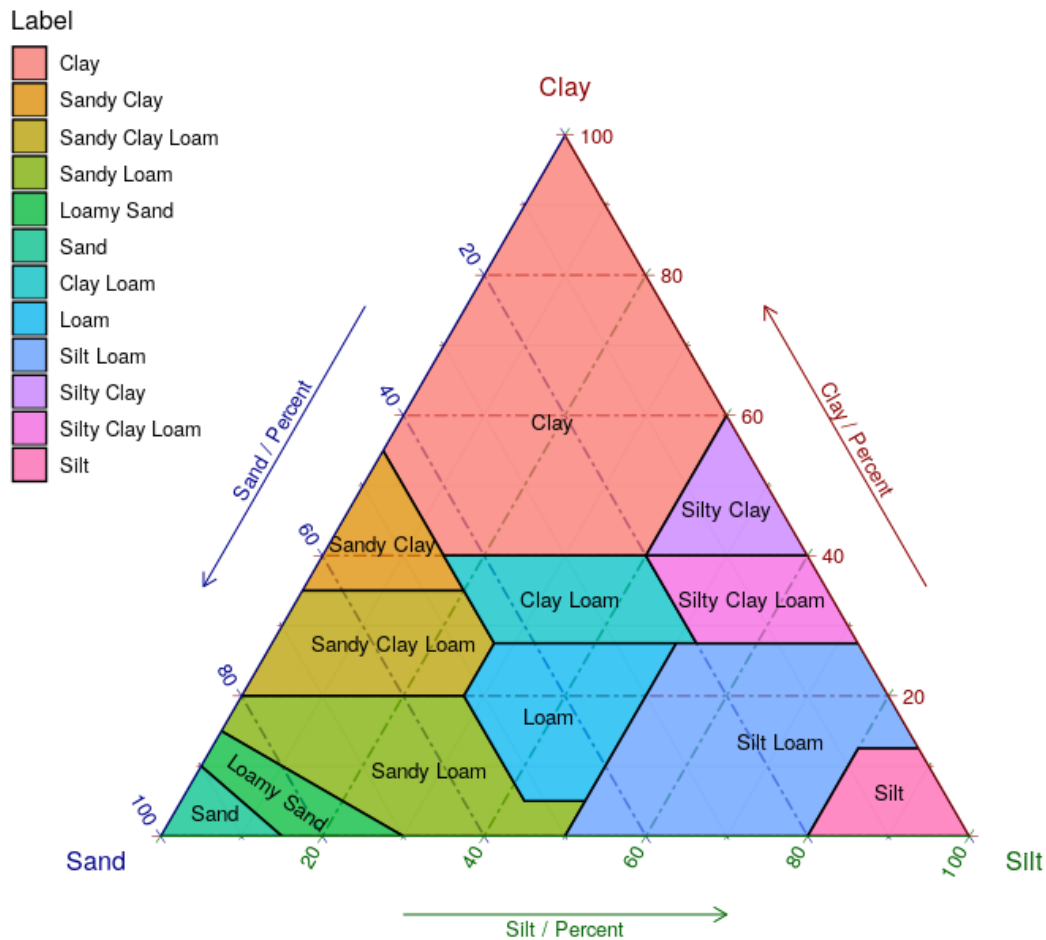
Figura 1 – Diagrama triangular utilizado na classificação textural do solo.
