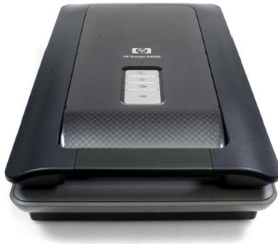
Figura 12 – Scanner de mesa utilizado para a aquisição das imagens de solo.
