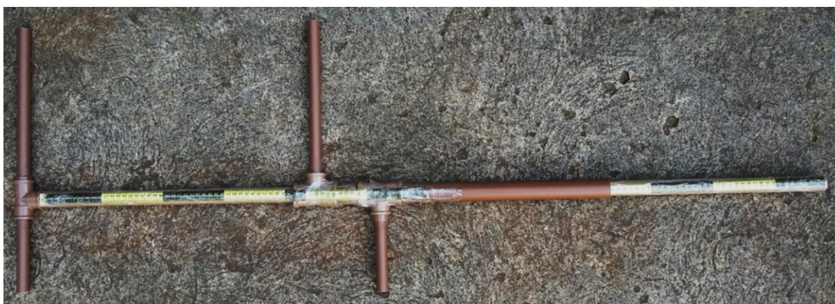
FIGURA 1 - Hipômetro construído com cano PVC, conforme especificação da Beefpoint, para análise das variáveis lineares de equinos do Centro de Equoterapia do CRER.
