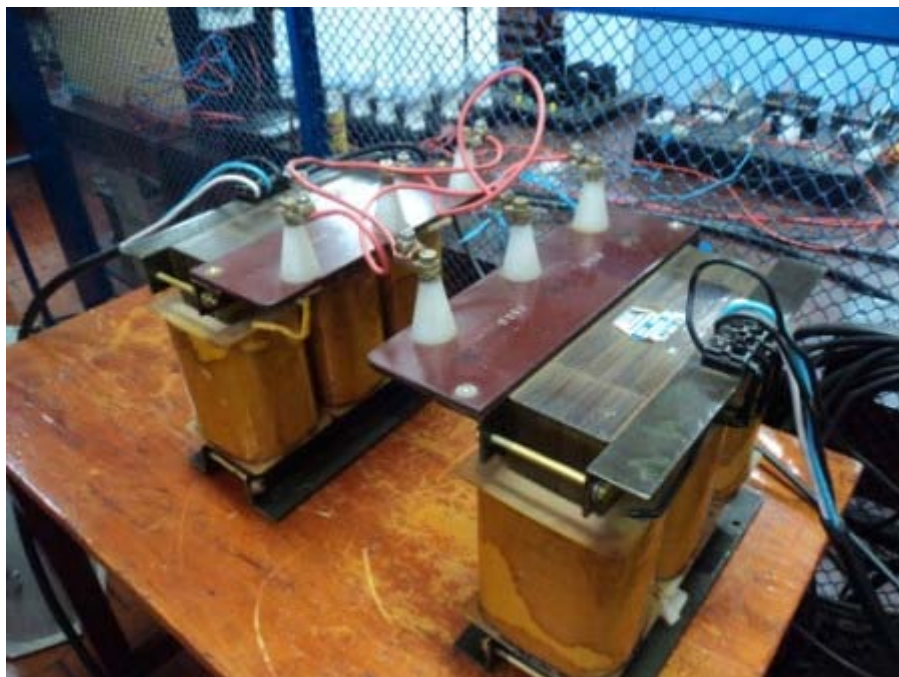
Figura D 3 – Transformadores do tipo seco conectados em back-to-back.
