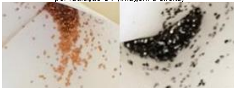
Figura 5.6.2: Comparação entre o glitter pristino (imagem à esquerda) e o glitter envelhecido por radiação UV (imagem à direita)
