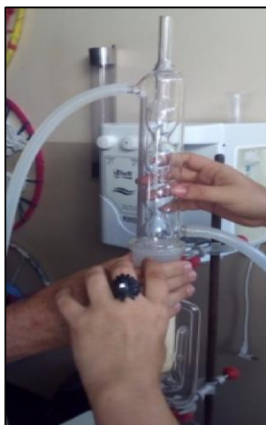
Figura 16 - Imagem do Extrator de Soxhlet sendo tateado pelos alunos DV.
