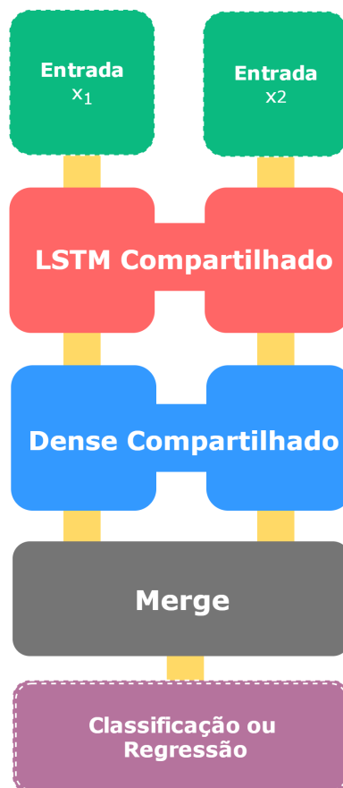
Figura 2.7: Exemplo de uma SCNN com diferentes tipos de camadas. Diferentes tipos de camadas podem ser utilizadas permitindo a extração de características complexas pela rede neural.
