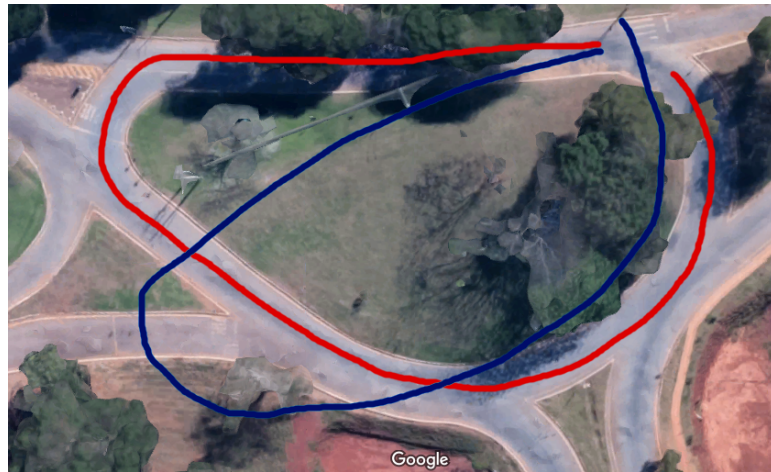
Figura 2.2: Efeito da remoção de outliers na estimativa da odometria. A cor vermelha representa a trajetória livre de outliers e a azul uma trajetória sem este refinamento.
