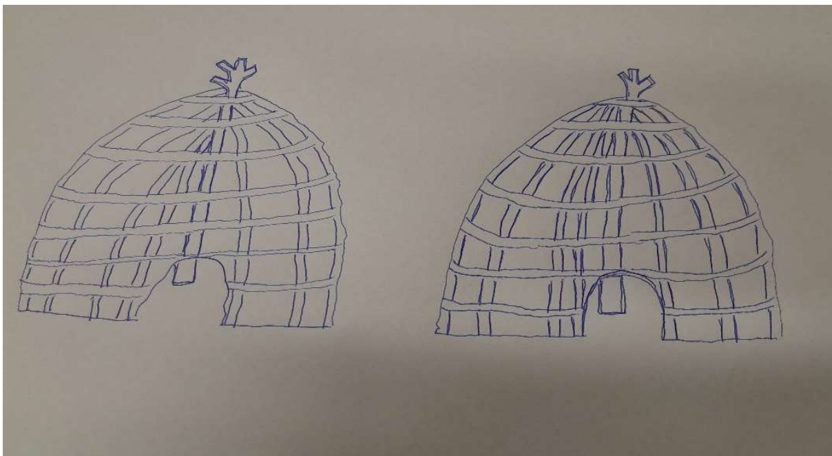
Figura 56: Terceiro passo para a construção da 'ri uptabire: colocação de um 'rãna.
