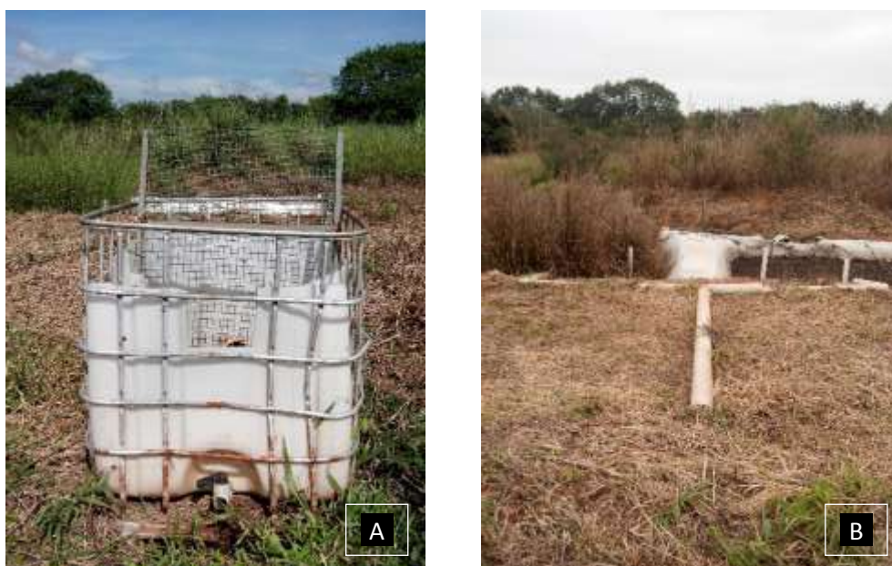
Figura 4.7: (A) caixa de recepção, gradeamento e distribuição do resíduo de fossa aplicado no sistema experimental; (B) sistema bipartido de distribuição dos resíduos de fossa nos leitos de tratamento do sistema experimental.
