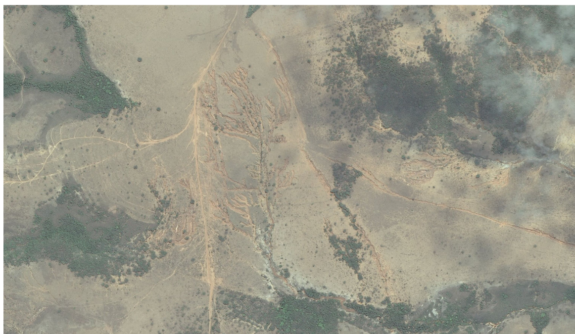
Figura 5.2.3. Voçoroca de grande porte formada pelo processo de ramificação e encontro de várias erosões.
