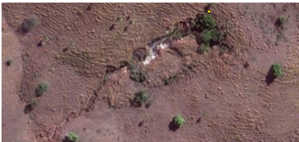
Figura 4.5.1: Identificação de uma feição erosiva por meio de imagem Geoeye, colorida e com resolução espacial de 0,5 metros em Mineiros (GO).
