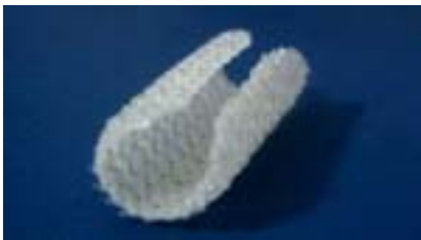
FIGURA 5 - Tela de polipropileno enrolada após aplicação do revestimento do filme de quitosana/polietilenoglicol.
