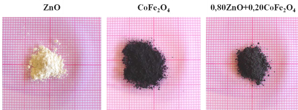
Figura 6.2 Amostras nano-particuladas obtidas por reação de combustão.
