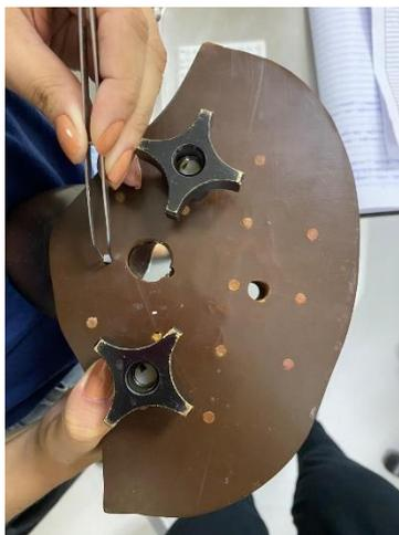
**Figura 5** – Colocação dos TLDs no simulador antropomórfico Alderson RANDO®
