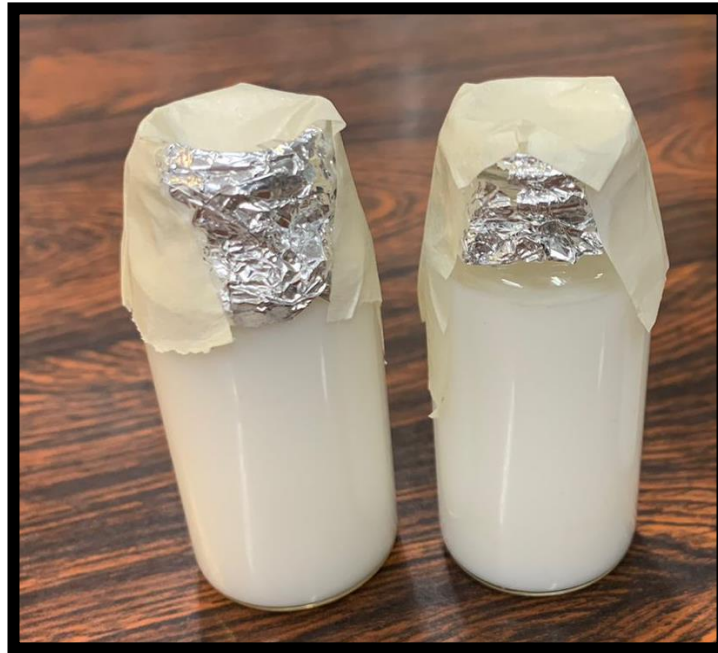
Figura 8: Nanoemulsão contendo óleo de melaleuca, com coloração branca e aspecto leitoso, sem anel de sedimentação, ambos os frascos são do mesmo protocolo (4) e foram armazenados em temperatura 2 °C a 8 °C.
