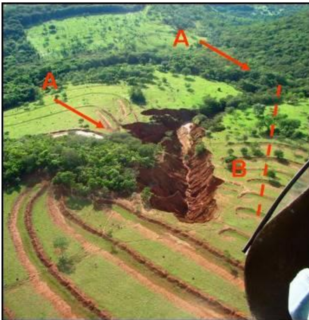
Figura 3. Vista aérea parcial da bacia de contribuição da Voçoroca Córrego do André. A: Rupturas de declive e, B: encosta na qual foram obtidos dados topográficos.
