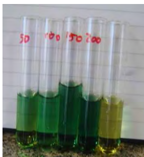
Figura 5. Padrão de frutose pelo método antrona modificada para cetoses. A concentração de frutose segue da esquerda para a direita (50 \mu L-200 \mu L). O tubo de coloração amarela é o branco
