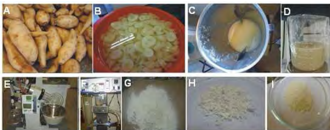
Figura 3. Esquema geral de obtenção do extrato seco de yacon, sendo (A) Raízes tuberosas de yacon; (B) Fatias imersas em solução de bissulfito; (C) Fatias de yacon trituradas; (D) Extrato aquoso; (E) Evaporador rotativo; (F) Spray dryer ; (G) Extrato seco obtido com aerosil; (H) Extrato seco obtido com maltodextrina; (I) Extrato seco com amido pré-gelatinizado.
