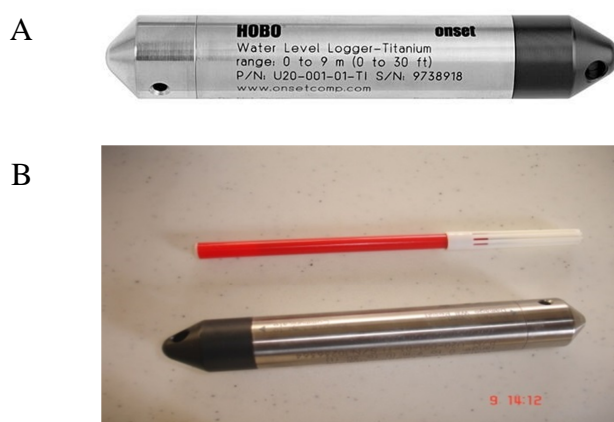
Figura 4.16 - Monitoramento da vazão: (A) HOB0 U20 Titanium Water Level Data Logger - U20 001-01-TI ; (B) medida do linígrafo. Fonte: Elaborado pela autora.
