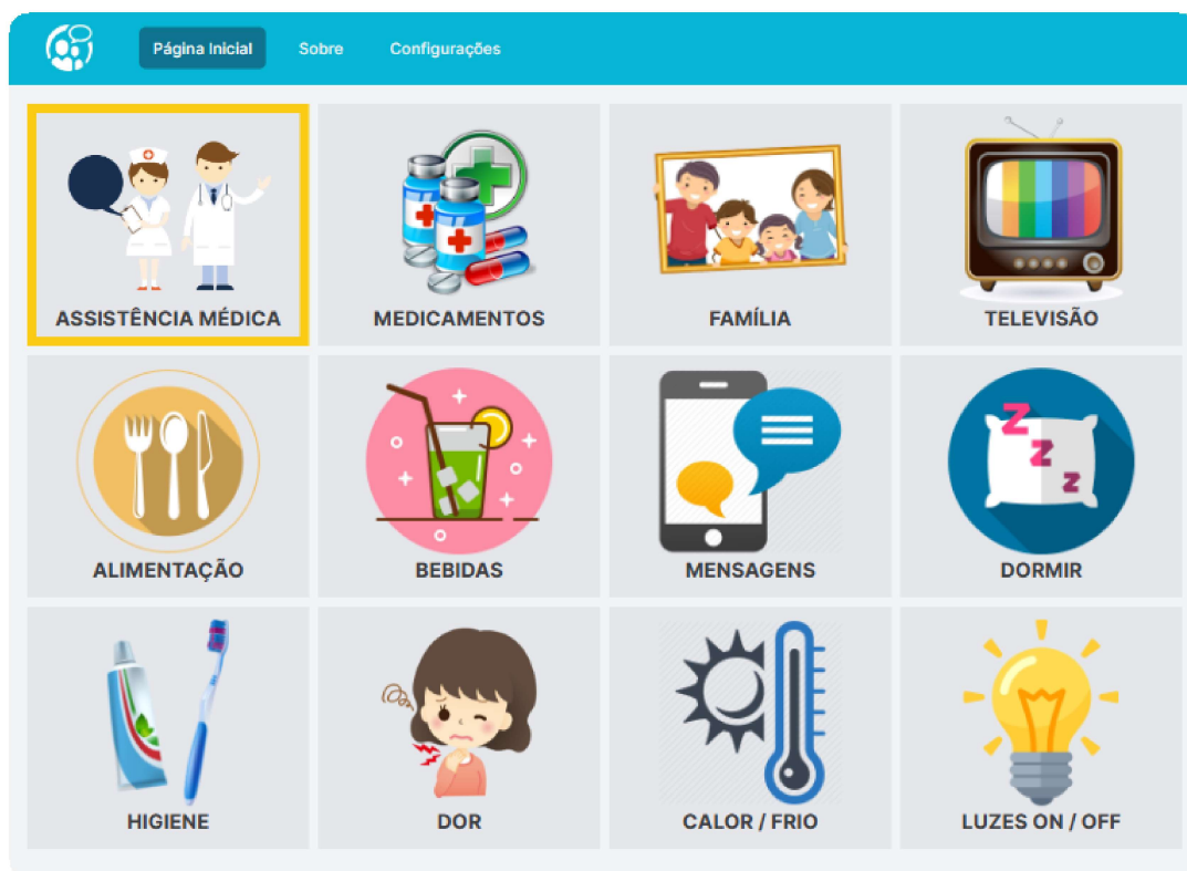
Figura 4.6 – Representação do padrão de exploração sequencial, onde cada opção fica selecionada por um intervalo de tempo, aguardando a confirmação do usuário.
