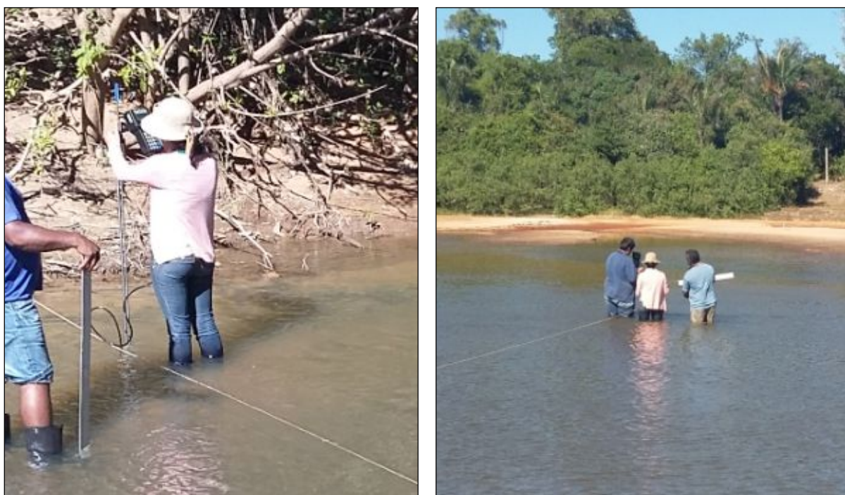
Figuras 7.3 e 7.4 – Medições de vazão utilizando o FlowTracker. Fonte: Fotos tiradas pelo autor.
