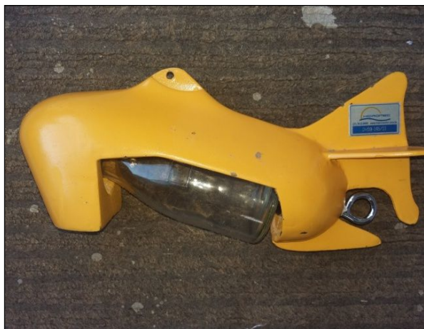
Figuras 7.11 e 7.12 - Coleta de sedimentos em suspensão por integração vertical, com destaque para o amostrador (DH – 59). Fonte: Fotos tiradas pelo autor.
