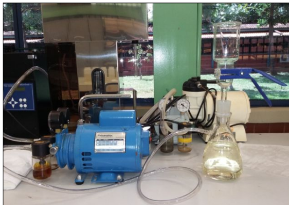
Figuras 7.13 e 7.14 – Análise de sólidos em suspensão, com destaque para o processo de filtragem das amostras com filtros de microfibra de vidro. Fonte: Fotos tiradas pelo autor.
