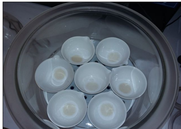
Figuras 7.13 e 7.14 – Análise de sólidos em suspensão, com destaque para o processo de filtragem das amostras com filtros de microfibra de vidro. Fonte: Fotos tiradas pelo autor.
