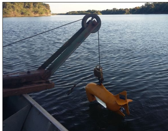
Figuras 7.11 e 7.12 - Coleta de sedimentos em suspensão por integração vertical, com destaque para o amostrador (DH – 59). Fonte: Fotos tiradas pelo autor.
