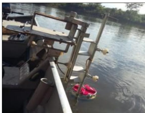
Figuras 7.6 e 7.7 – Medições de vazão utilizando ADCP. Fonte: Fotos tiradas pelo autor.
