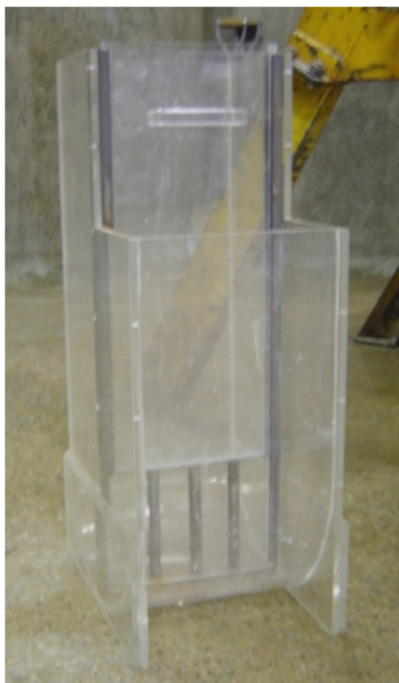
Figura 2. 8 - Vista frontal da Caixa U
