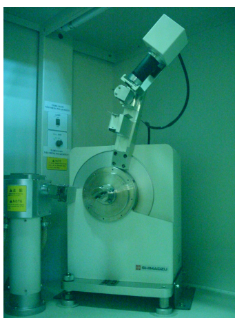
Figura 3.15: Difratômetro com a geometria de Bragg-Brentano (Shimadzu XRD 6000), instalado no IQ/UFG usado para caracterização das amostras.
