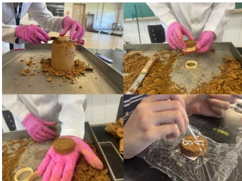
Figura 3.12 - Preparação de amostras para execução do ensaio de absorção e retração, extração do topo, meio e base do CP
