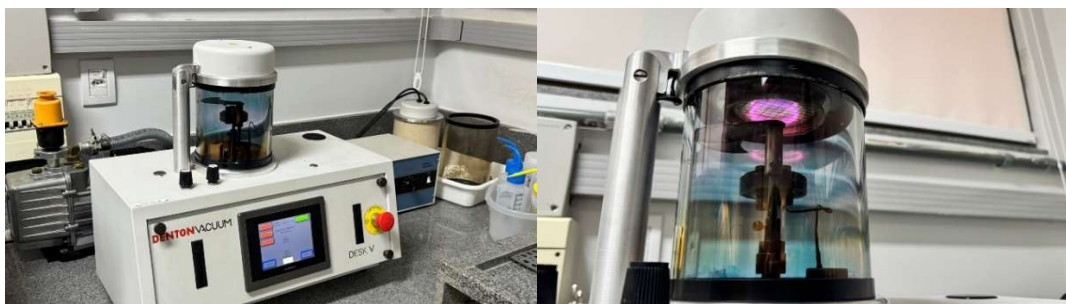
Figura 3.6 - Preparação de amostras: processo de metalização
