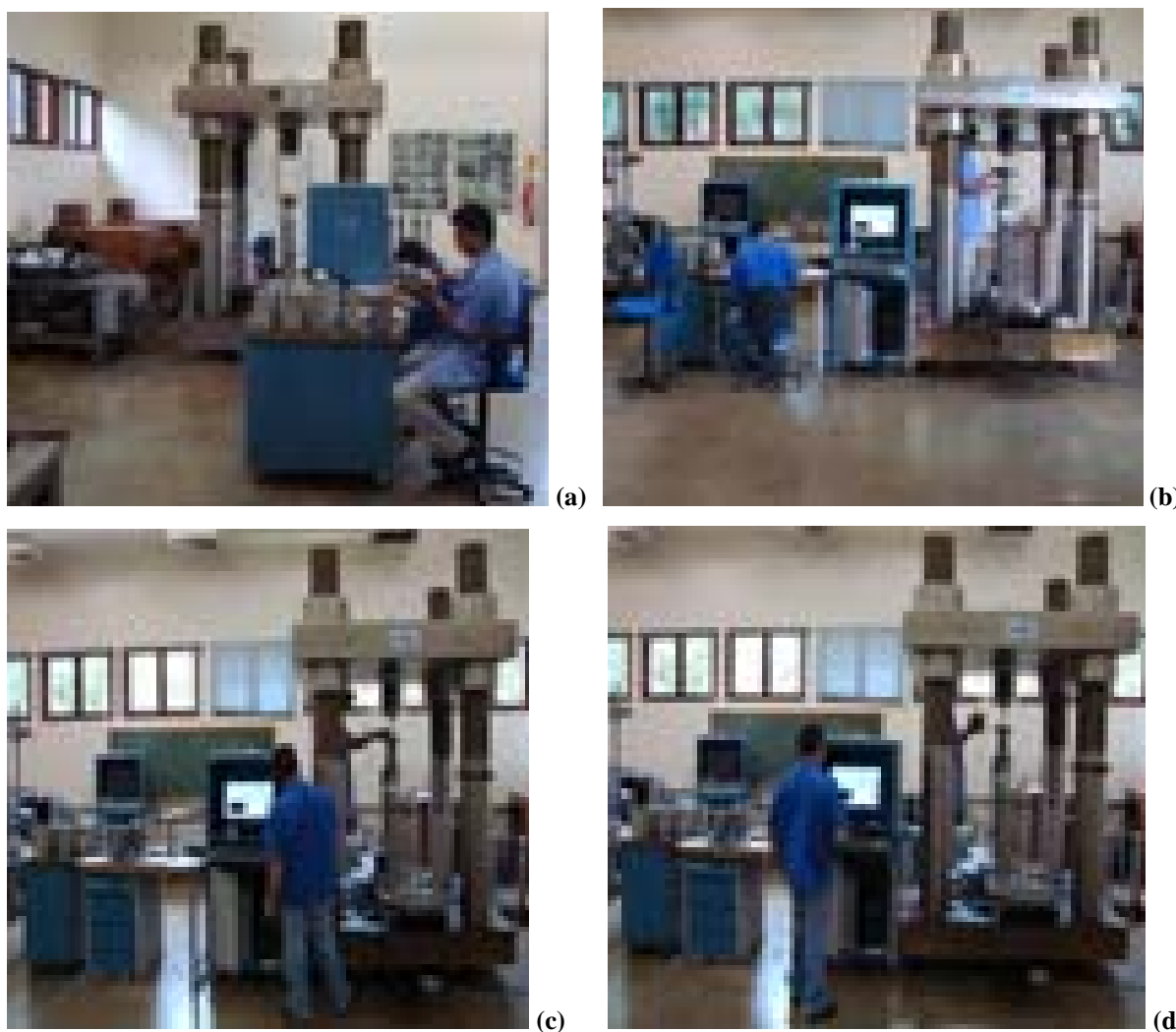
FIGURA 3.20 – Preparação do corpo-de-prova para Ensaio de Determinação do Módulo de Deformação do Concreto utilizando LVDT (Transdutor Diferencial de Variação Linear) (a), (b), (c) e (d), realizado no Laboratório de Rochas do Departamento de Apoio e Controle Técnico de Furnas Centrais Elétricas S.A. em Goiânia-GOÍÁS.
