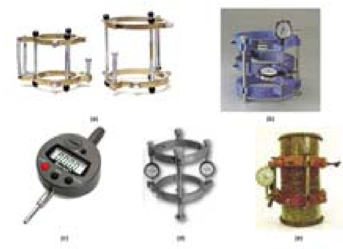
FIGURA 2.12 – Instrumentos para medição da deformação: (a) dispositivos compressômetros; (b) compressômetro-expansômetro; (c) relógio comparador; (d) compressômetro com 2 relógios comparadores; (e) compressômetro com 1 relógio comparador (MONTIJA, 2007).
