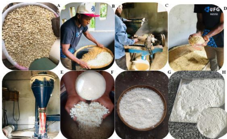
Figura 2. A) Milho debulhado, B) Separação em peneiras artesanais de palha, C) Degerminação feita em descascador: maize sheller/maize peeler + grinder, D) Farelo e casca, E) Moagem do grão em Cyclone Hammer Mill, F) Maceração em balde com água por 24h, G) Redução da umidade com exposição ao sol, H) Farinha. Fonte: Autor, (2025)
