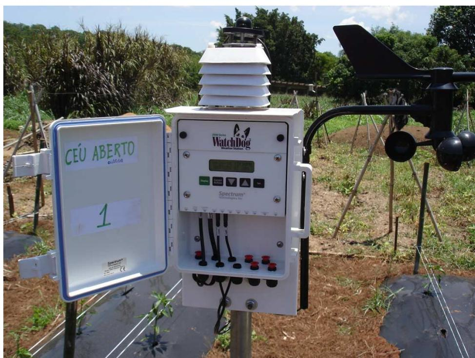
**Figura 11.** Sistema de aquisição automática dos dados meteorológicos a Céu aberto.
