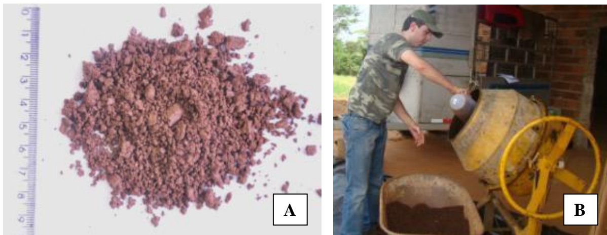
Figura 10 – (A) Lodo após ser fragmentado com auxílio de uma peneira, (B) Utilização de uma betoneira pra preparação dos tratamentos.
