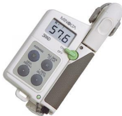
Figura 19 – Medidor portátil de clorofila SPAD-502 utilizado para medição do teor de clorofila nas folhas das mudas do experimento.
