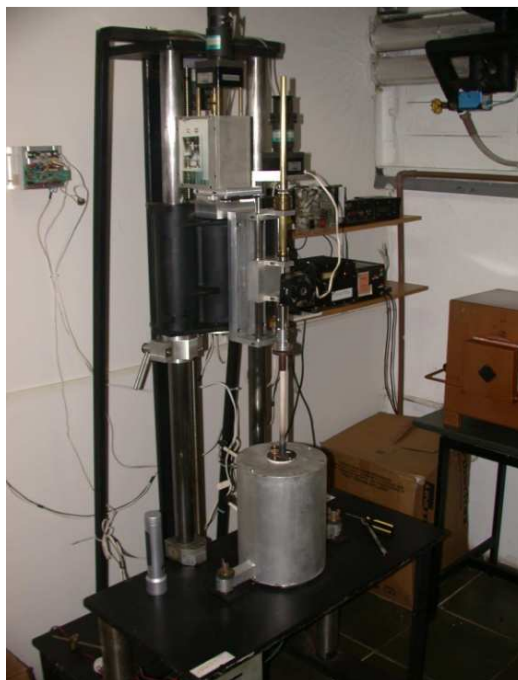
Figura 2.3 Forno de crescimento de cristais, por fusão, do Laboratório de Cristalografia e Materiais do IF/UFG.
