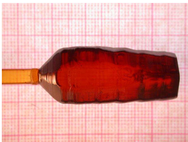
Figura 3.15- Fotografia do BTO:Zr-06.01 crescido à partir de solução com composição 10\text{Bi}_2\text{O}_3:0,95\text{TiO}_2:0,05\text{ZrO}_2 .
