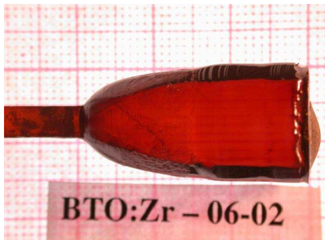
Figura 3.16- Fotografia do BTO:Zr-06.02, crescido da solução remanescente do crescimento do BTO:Zr-06.01
