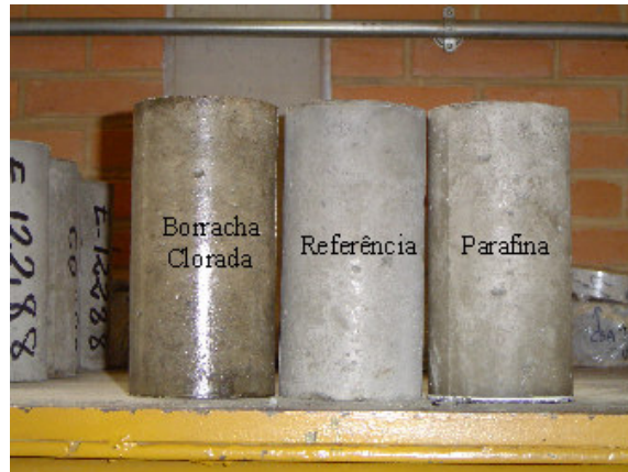
Foto 4.11 - Superfície dos corpos de prova após a aplicação da membrana química de cura e do corpo de prova de referência.
