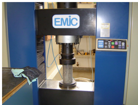
Foto 4.15 – Ensaio para determinação da resistência à compressão.
