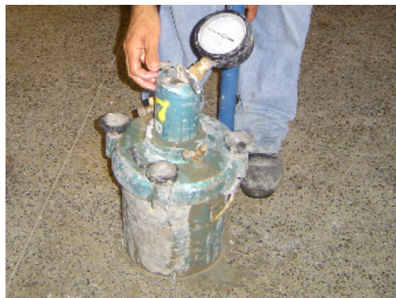
Foto 4.5 – Ensaio para determinação do teor de ar incorporado.
