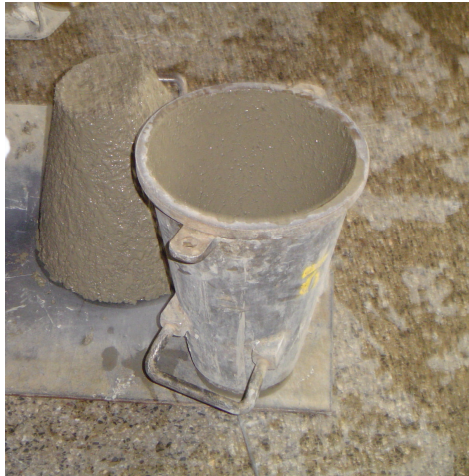
Foto 4.3 – Ensaio de consistência pelo abatimento do tronco de cone.
