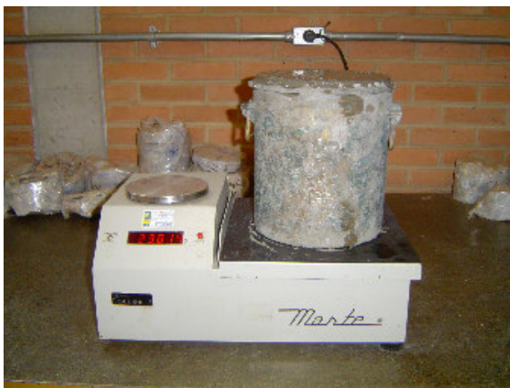
Foto 4.4 – Ensaio para determinação da massa específica do concreto.
