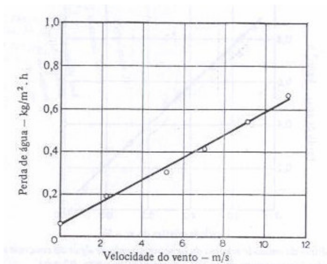
Figura 3.4 – Influência da velocidade do vento sobre a perda de água do concreto nas primeiras idades (umidade relativa 70%; temperatura do ar 21°C) (NEVILLE, 1997).
