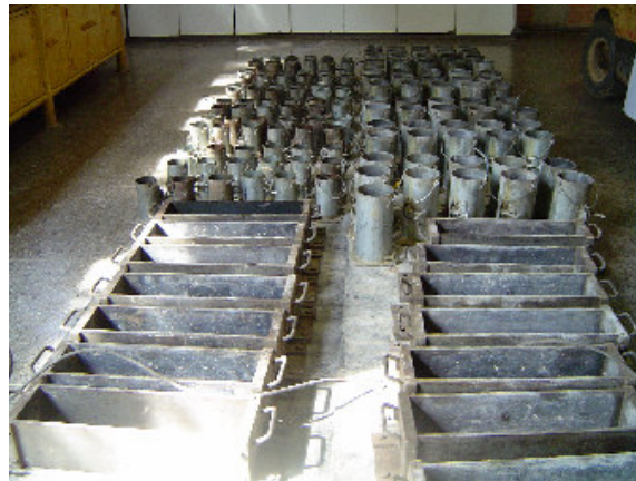
Foto 4.6 – Formas preparadas para a moldagem.
