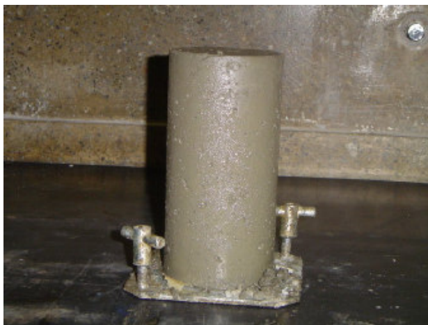
Foto 4.8 – Desforma do corpo de prova 8 horas após a moldagem.
