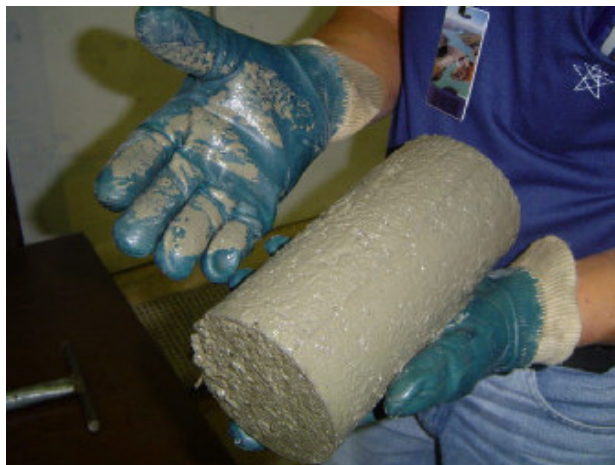
Foto 4.7 – Desforma do corpo de prova 5 horas após a moldagem.
