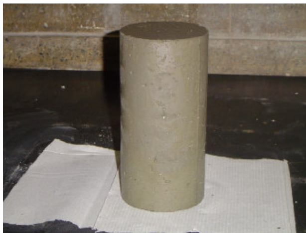
Foto 4.9 – Desforma do corpo de prova 12 horas após a moldagem.
