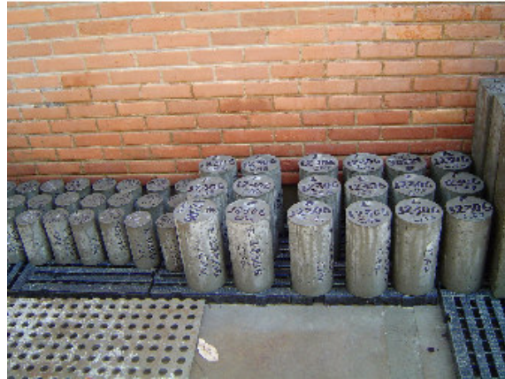
Foto 4.14 – Local de armazenagem dos corpos de prova destinados ao processo de cura por molhagem.
