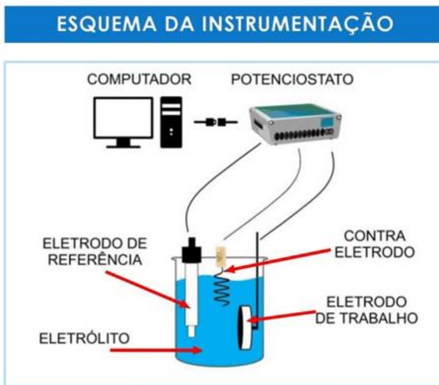
Figura 4. Esquema da instrumentação usada na eletroanálise.
