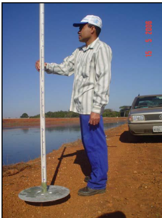
Figura 14 – Aferidor de lodo utilizado na batimetria das lagoas anaeróbias. Fonte: Pereira, (2007).
