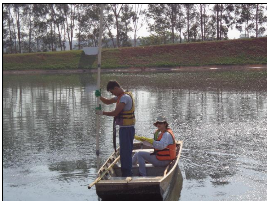
Figura 13 - Operação de medição do lodo nas lagoas anaeróbias da ETE – Anápolis – Go.
