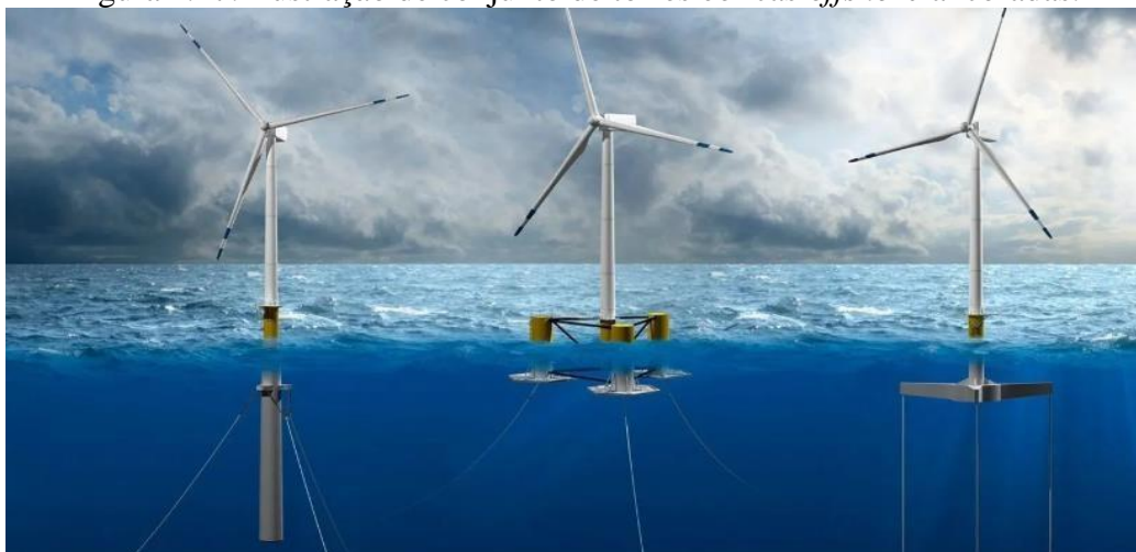
Figura 2.17: Ilustração de conjunto de torres eólicas offshore ancoradas.
