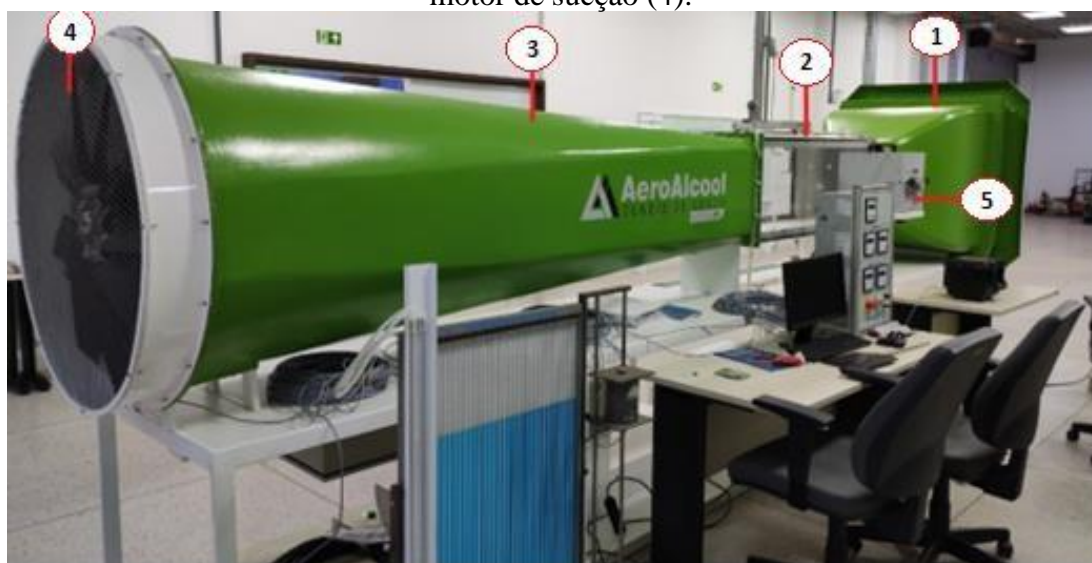
Figura 5.1: Túnel de vento mostrando a entrada de ar (1), região de ensaios (2), difusor (3) e o motor de sucção (4).
