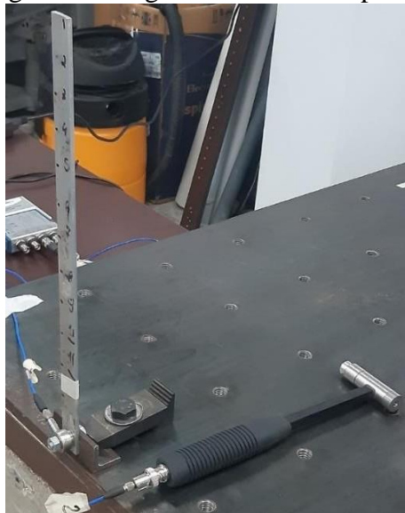
Figura 5.9: Viga e Martelo de Impacto.
