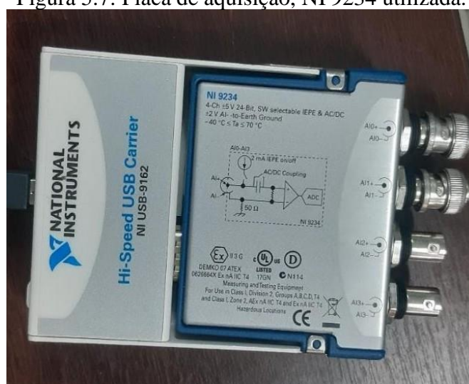
Figura 5.7: Placa de aquisição, NI 9234 utilizada.
