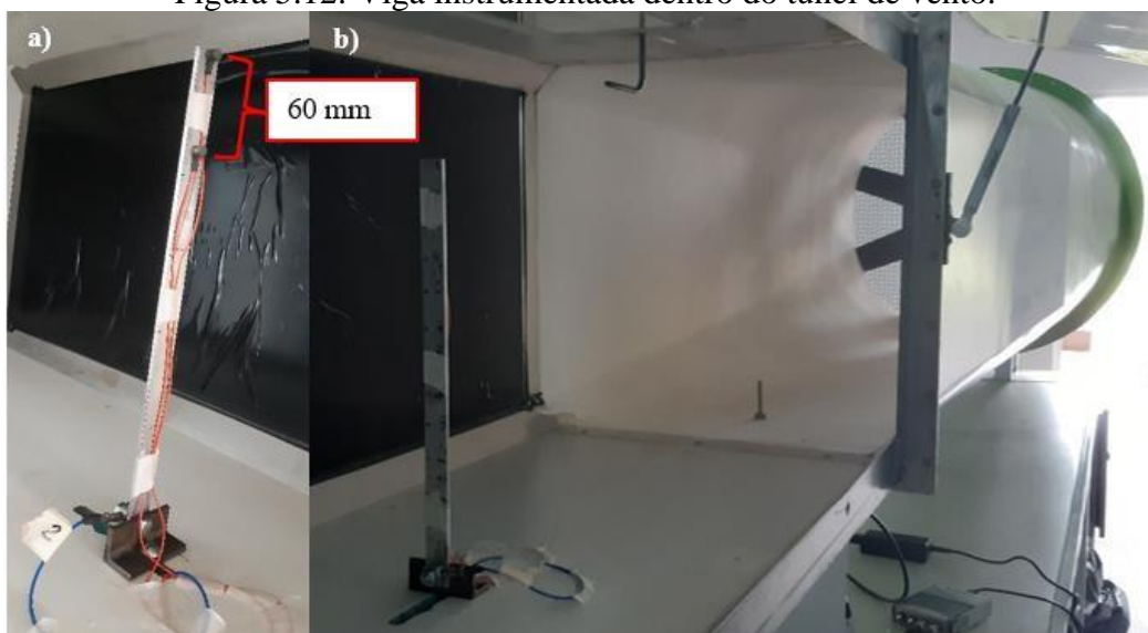
Figura 5.12: Viga instrumentada dentro do túnel de vento.
