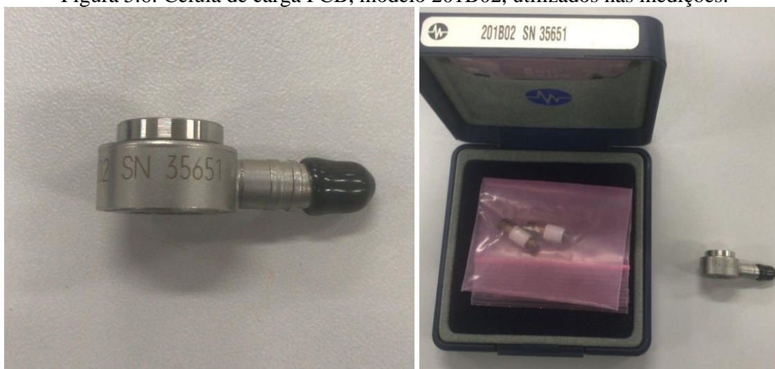
Figura 5.6: Célula de carga PCB, modelo 201B02, utilizados nas medições.
