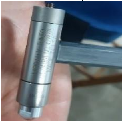
Figura 5.8: Martelo de impacto utilizado.
