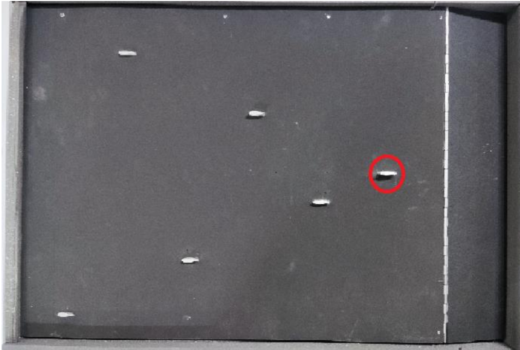
Figura 29. Placa de Camada Limite destacando o conjunto de sensores escolhido
