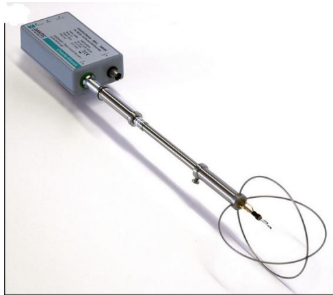
Figura 12. Exemplo de um anemômetro de fio quente
