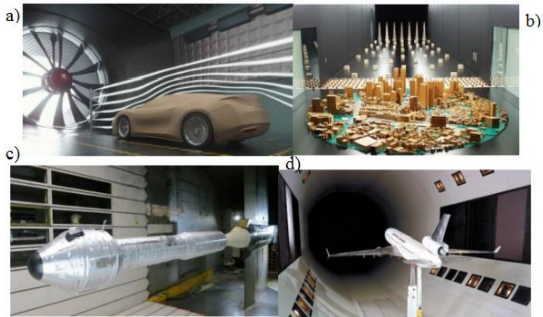
Figura 5. Exemplos de aplicação do túnel de vento: Automobilística (a), Engenharia Civil (b), Aeronáutica (c) e (d).
