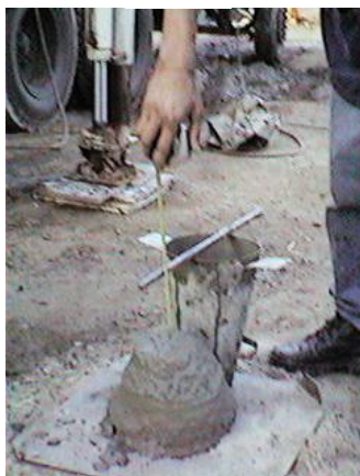
FIGURAS 5.12 – (a) Cone de Abrams sobre a chapa nivelada. (b) Demais instrumentos (haste, colher, régua ou trena). (c) Adensamento. (d) Retirada do cone. (e) Medição. (UEPG)
