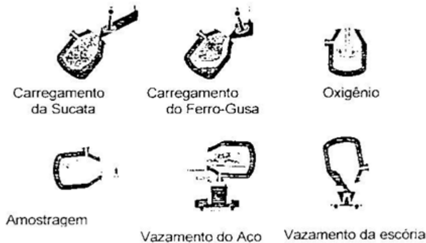
Figura 2.5 – Processo de refino do aço através de conversor LD (MOORE e MARSHALL apud MASUERO, 2001).
