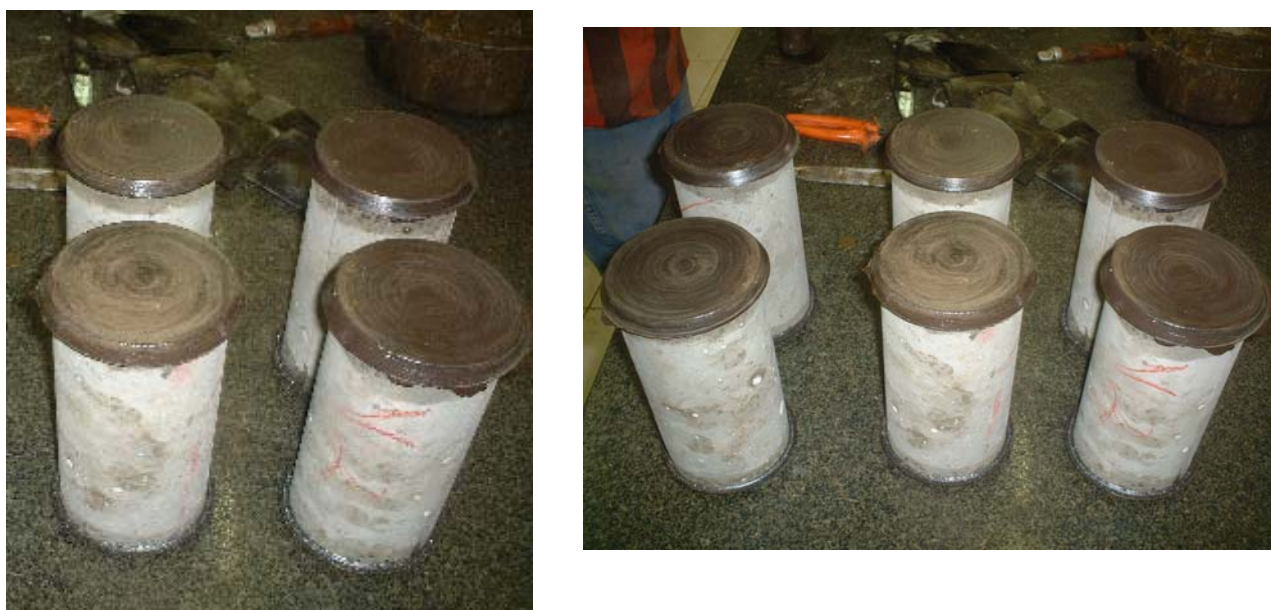
FIGURA 5.13 – CPs capeados com enxofre para ensaio.
