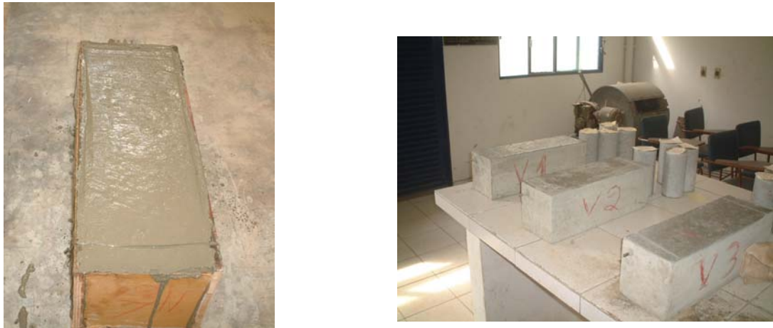
FIGURA 5.4 – (a) Fôrma preenchida com concreto. (b) Vigas de concreto.
