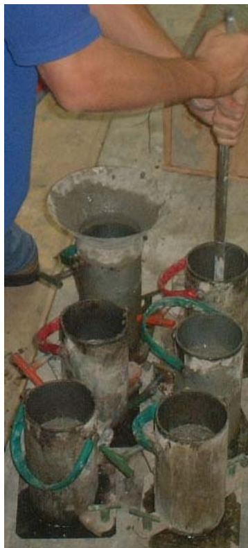
FIGURA 5.5 – Moldagem dos CPs cilíndricos.
