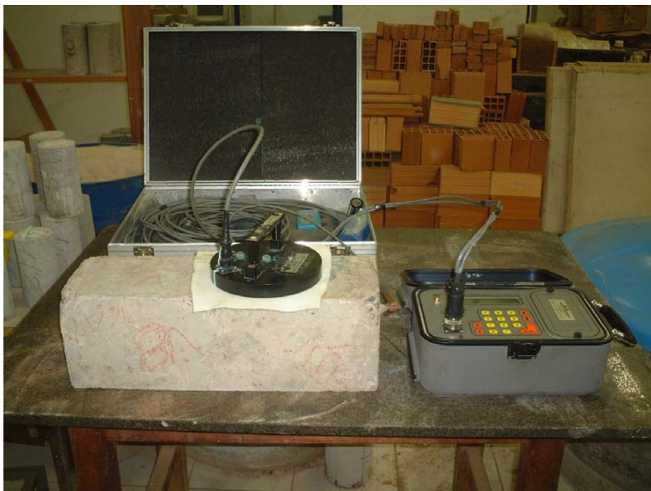
FIGURA 5.17 – GECOR6 – aparelho utilizado para realizar leituras eletroquímicas nas vigas de concreto.
