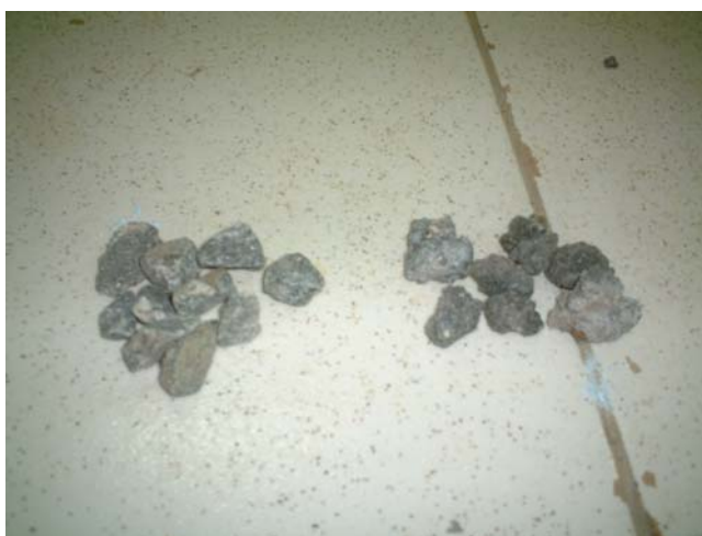
FIGURA 5.1 – Escória de aciaria elétrica e micaxisto. (Lado esquerdo – Micaxisto; Lado direito – Escória)
