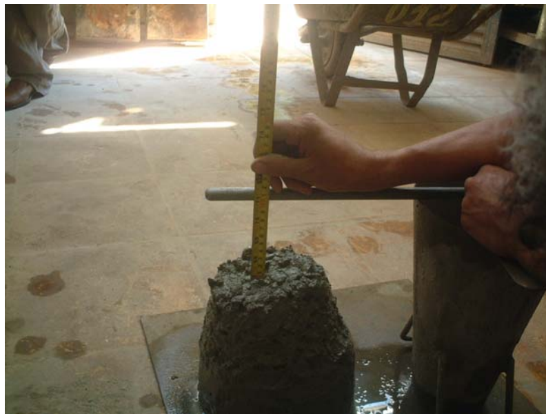
FIGURA 6.3 – Medição de abatimento.
