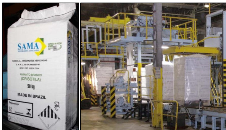
Embalagem contendo as fibras do amianto crisotila prontas para serem comercializadas (à esquerda) e fardos envolvidos em material plástico termo-retrátil (à direita)
