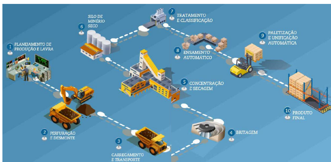
Infográfico: Processo produtivo do amianto crisotila em Minaçu
