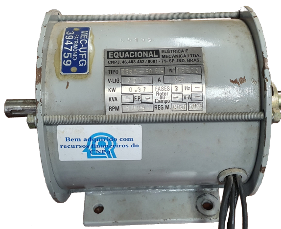
Figura 4.2 – Motor a Relutância Variável 6x4 usado como base para este trabalho
