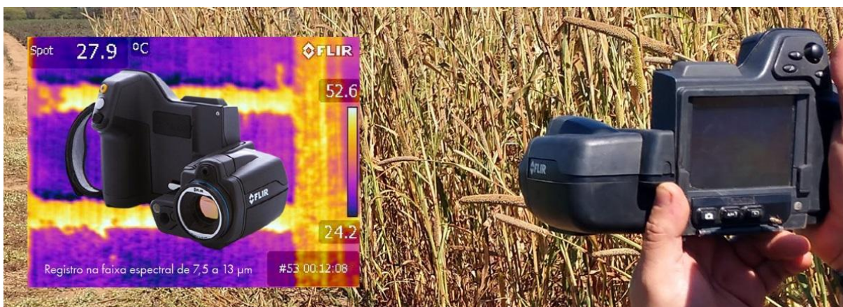
Figura 14 - Sensor Termográfico marca Flir, modelo T-420.
