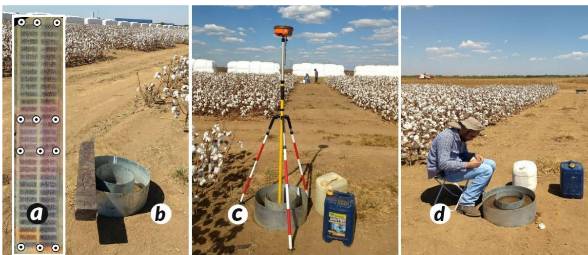
Figura 9 - (a) Distribuição dos pontos de infiltração; (b) Instalação; (c) Georreferenciamento do ponto e; monitoramento da infiltração do solo por anéis de infiltração na Área 1.
