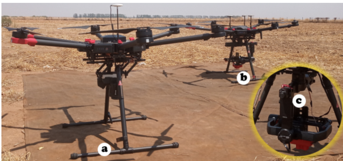
Figura 12 - Matrice 600 (a); Matrice 600-PRO (b) e; no detalhe, Gimbal Ronin-MX (c).
