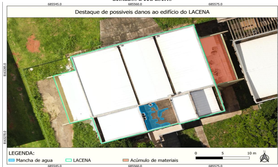
Figura 44 – Edifício do Lacena com destaques para manchas de umidade e acúmulo de materiais deixados a céu aberto
