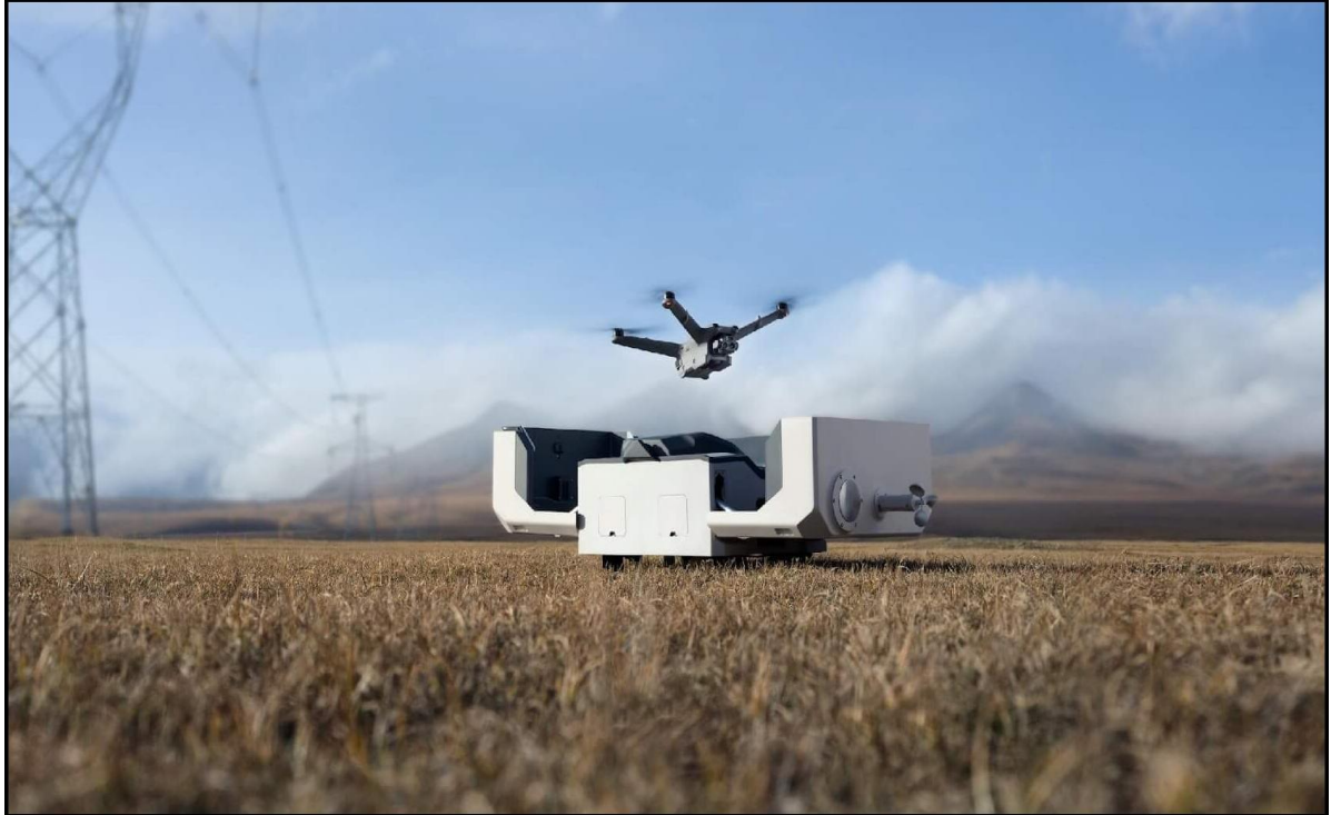
Figura 52 – Plataforma DJI Dock 2 sob o drone Matrice 3D/3TD em posição de pouso ou decolagem
