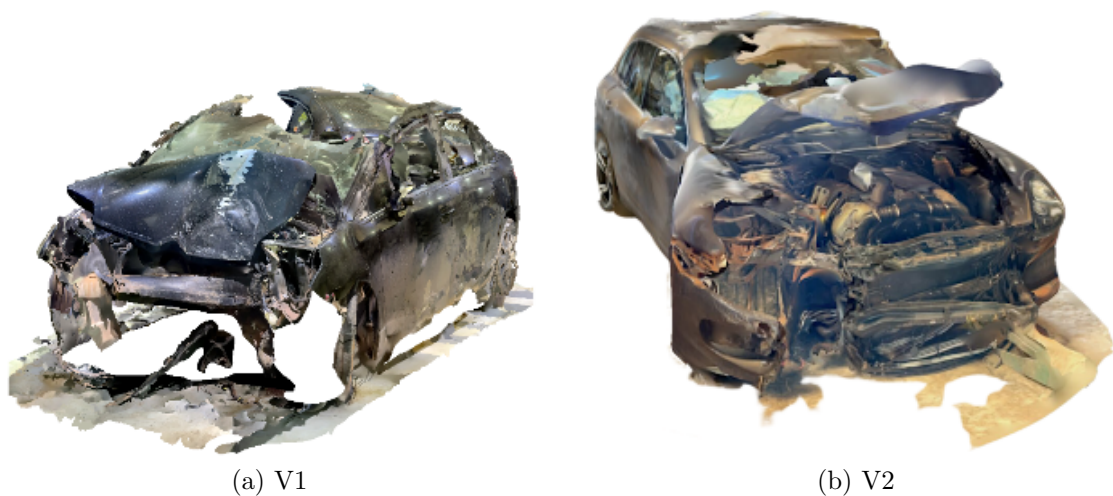
Figura 11 – Escaneamento 3D dos veículos utilizando o sensor LiDAR.
