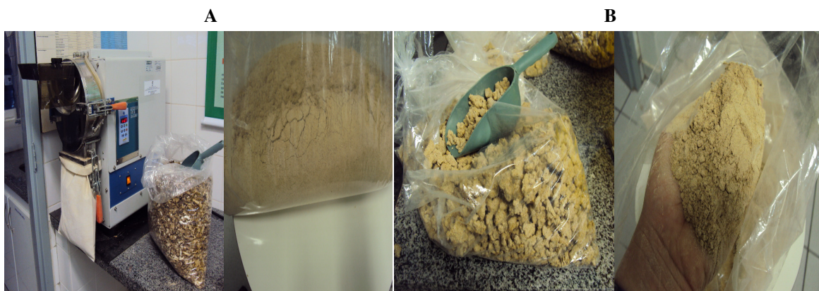
Figura 12. Moinho e cascas desidratadas antes e após moagem (A) e bagaço desidratado antes e após moagem (B)
